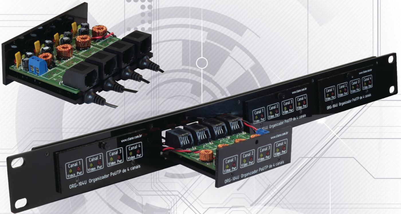
Organiza a instalação das câmeras de segurança, convertendo o sinal de vídeo e enviando a alimentação (12V) através de um cabo UTP de até 400 metros. Possui rabichos injetados para a conexão com o equipamento de gravação (DVR) e leds indicadores.
